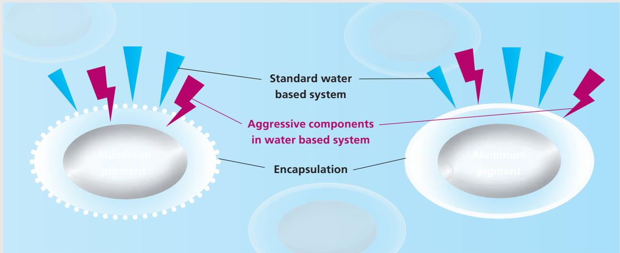
Dank der komprimierten SiO<sub>2</sub>-Einkapselung halten die Aluminiumpigmente von STAPA® IL HYDROLANplus auch aggressivsten Komponenten stand. / Thanks to their compact SiO<sub>2</sub> encapsulation, the aluminum pigments of STAPA® IL HYDROLANplus can even withstand the most aggressive components.
