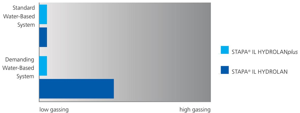
Die Grafik zeigt, dass die Gasungsstabilität von STAPA® IL HYDROLANplus auch in besonders anspruchsvollen wässrigen Systemen erhalten bleibt. / The image shows that the gassing stability of STAPA® IL HYDROLANplus even carries over to very challenging aqueous systems.
